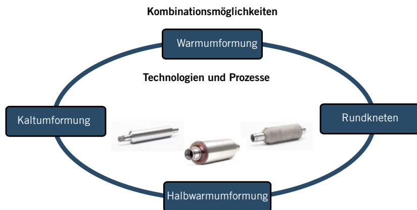
BILD 4 Verfahrenskombinationen bei der Herstellung von Rotorwellen (© Hirschvogel Umformtechnik)
